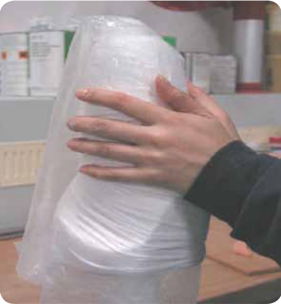
5. ラミネーションアンカーを外し、ドーム型ダミーを取付けたモデルに PVA バッグ (99B81) をかぶせます。
